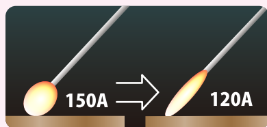
アーク長が長くなり電圧が上昇することで、電流が減少
