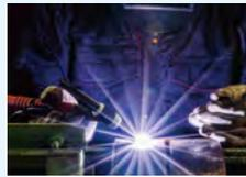
自動アイドリングストップの解除は、**溶接棒で母材を軽く叩く**か、100Vコンセントにつないだ**電動工具の電源をON→OFF→ON→OFF**でエンジンが再始動します。(安全のためONのままでは再始動しません)
