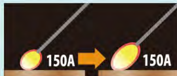
アーク長が長くなり電圧が上昇するが、電流は変化せず
