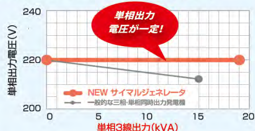
25kVA機 単相3線側電圧変動比較(60Hz時)
