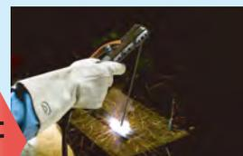
自動アイドリングストップの解除は、溶接棒で母材を軽く叩くか、100Vコンセントにつないだ電動工具の電源をON→OFF→ON→OFFでエンジンが再始動します。(安全のためONのままでは再始動しません)
