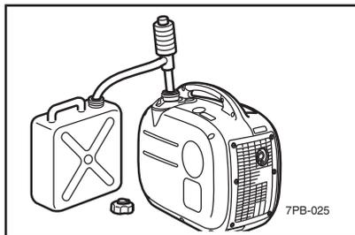
4. 燃料給油キャップおよびストレーナを取り付け、燃料給油キャップつまみを OFF（閉）③ にします。
