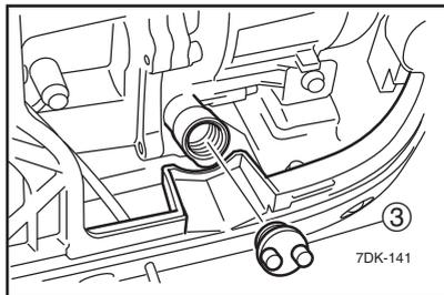
6. 発電機本体を傾けてエンジンオイルを抜きます。
