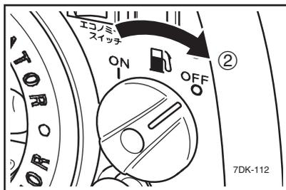
3. 燃料給油キャップおよびストレーナを取り外し、市販のポンプを使用して燃料（自動車用レギュラーガソリン）を抜きます。なお、電動式ポンプは使用しないでください。
