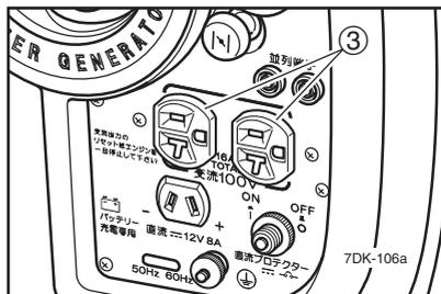
交流コンセント③には単相 100V で合計消費電力 16A 以下の電気器具のプラグを差し込みます。
