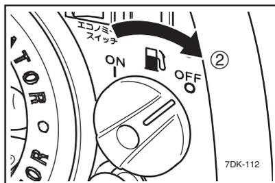
5. エンジンが十分に冷えてから、燃料給油キャップつまみを OFF（閉）③にします。
