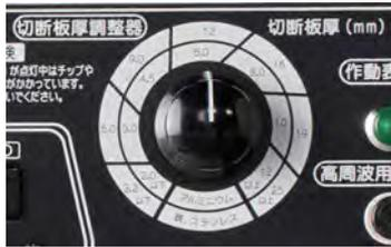
条件に設定できます。切断速度は軟鋼12mm厚の場合、ガス切断に比べ2倍、9mm厚で3倍の速さで切断ができます。また、高価で資格が必要なガスを一切使用しないので安全に作業ができます。しかも、ガス切断と比較してランニングコストは約1/2と、とても経済的です。
