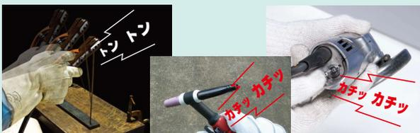
自動アイドリングストップの解除は、溶接棒で母材を軽く叩くか、トーチスイッチを2回押すか、100Vコンセントにつないだ電動工具の電源をON→OFF→ON→OFFでエンジンが再始動します。(安全のためONのままでは再始動しません)
