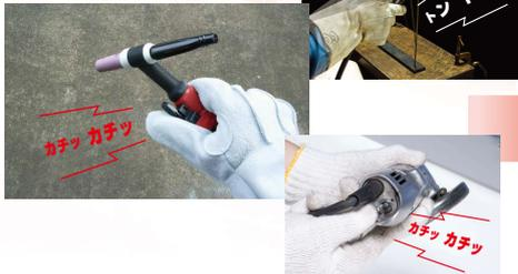
自動アイドルストップの解除は、トーチのボタンを2回押す、溶接棒で母材を軽く叩く、100Vコンセントにつないだ電動工具の電源をON→OFF→ON→OFFのいずれかの動作でエンジンが再始動します。(安全のためONのままでは再始動しません)
