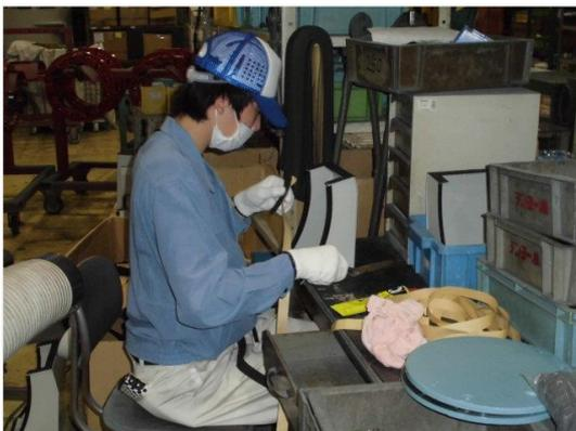
艀装部品へのシール材貼付け作業
