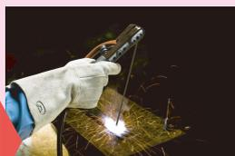
自動アイドリングストップの解除は、溶接棒で母材を軽く叩くか、100Vコンセントにつないだ電動工具の電源をON→OFF→ON→OFFでエンジンが再始動します。(安全のためONのままでは再始動しません)
