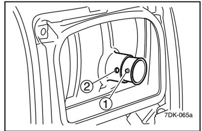
6. マフラーワイヤネットとマフラーキャップを取り付け、ボルトを締め付けます。
