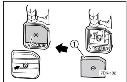
8. エアクリーナカバーを元の位置に戻し、取り付けスクリュで締め付けます。
