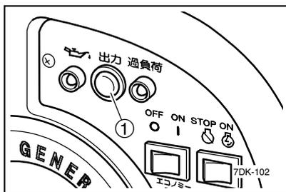
4. エコノミーコントロールスイッチをON（作動中）①にします。
