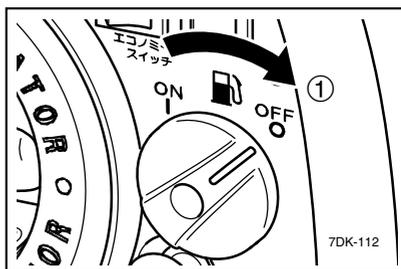
5. エンジンが十分に冷えてから、燃料給油キャップつまみをOFF（閉）①にします。
