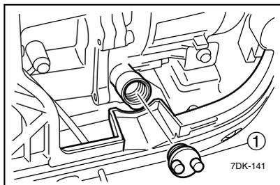
5. 発電機本体を傾けてエンジンオイルを抜きます。
