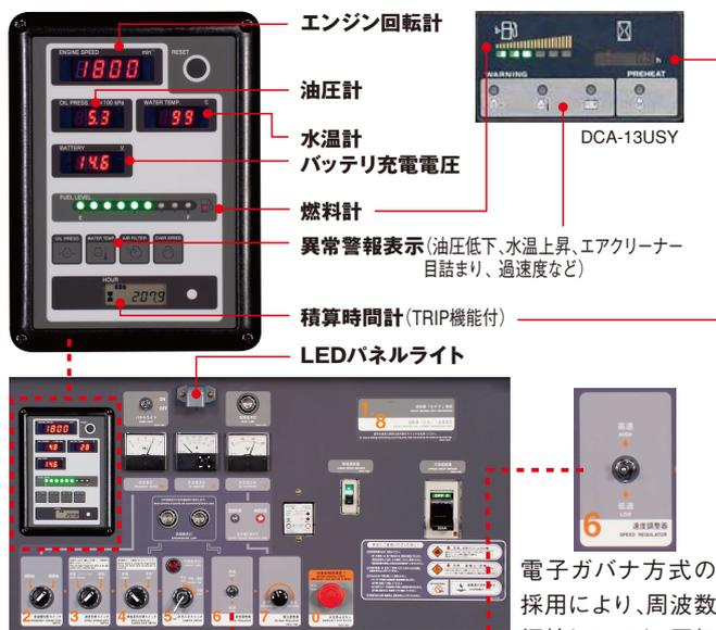
操作手順にそったスイッチレイアウトに、各スイッチに番号が表記されているので、誰にでも安全に確実に始動・停止できます。
