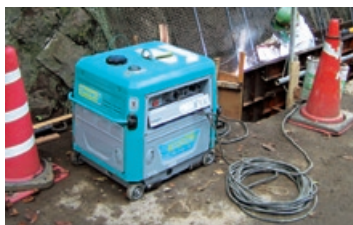
（法面の型枠溶接作業に使用されるエンジン溶接機）
